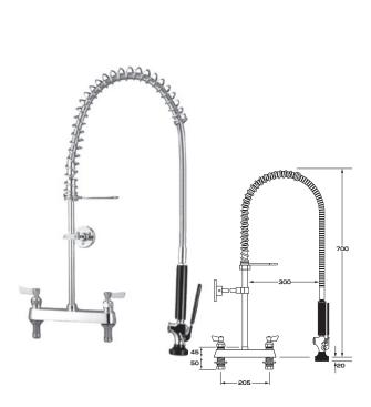
2310(立型プレリンスユニット)のライザーパイプを300mmに変更し、高さを240mm低く(全高:約700mm)したモデルです。 (接続径:1/2インチ)
