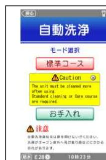
※リンスアップ剤を使用しない洗浄コース（簡単、すすぎ）を続けると、蒸気発生器の洗浄が行われない為、リンス剤を使用した洗浄を促す画面が左記のように表示されます。画面に従い洗浄を行って下さい。
