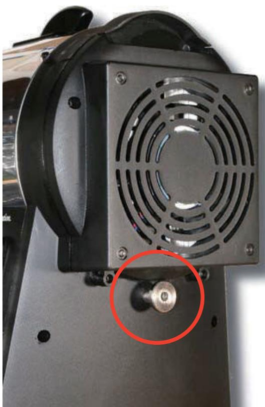
**重要：緊急排出装置は、以下のような緊急事態でのみ使用するように設計されています。通常の操作では、必ず操作パネルの「EJECT」ボタンを押して、豆を焙煎ドラムから冷却トレイに取り出してください。**
