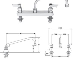
指1本で素早い水栓の開閉が可能な横型湯水混合栓です。全閉⇔全開のハンドルレバー回転角度は約200度です。逆流防止弁は装着されていません。
