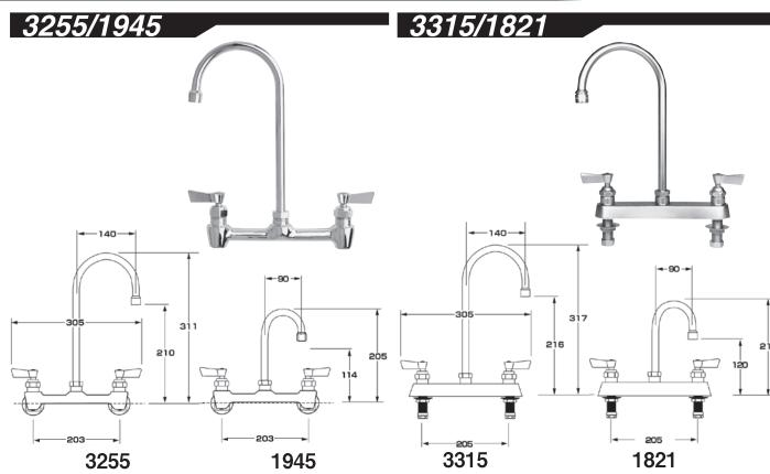
指1本で素早い水栓の開閉が可能な、グースネックスタイルの横型湯水混合 栓です。全閉⇔全開のハンドルレバー回転角度は約200度です。 湯水芯々 寸法は203mm固定です。逆流防止弁は装着されていません。 (接続径:1/2インチ)
