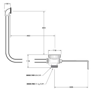
フラット型ストレーナーの ドレンバルブにオーバーフ ローチューブ(φ32)を装 着したモデルです。オーバ ーフローチューブは、必要 な長さにカットしてご使用 できます。 (接続径:外側2インチ/内
