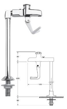
プッシュバック方式のシングルヘッド・グラスフィラーで水量調節バルブが付いています。 (接続径:3/8インチ)(1/2インチ変換アダプター付)
