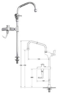
グラスフィラーとピッチャーフィラーのコンビ ネーションタイプで、グラスフィラーには水量 調節バルブが付いています。 (接続径:3/8インチ)(1/2インチ変換アダプター付)
