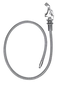
長さ1530mmのホースを備えた、省スペース タイプのカウンター埋込式グラスフィラーで、 必要な時に引き出して使用します。 (カウンター埋込用ソケット付) (接続径:1/4インチ)(1/2インチ変換アダプター付)
