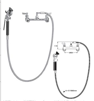
広範囲にわたって使用可能な、スプレーヘッドが45度傾いた使いやすい 横型スプレーユニットで、ホースの長さは1530mmです。 湯水芯々寸法は203mm固定です。逆流防止弁が装着されています。 (壁面フック付) (接続径:1/2インチ)
