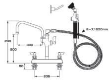
2370(立型スプレーユニット)に、フォーセットを取り付けたユニットです。 (壁面フック付)(接続径:1/2インチ)
