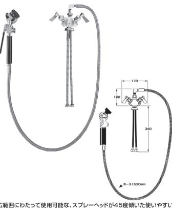
広範囲にわたって使用可能な、スプレーヘッドが45度傾いた使いやすい 立型スプレーユニットで、ホースの長さは1530mmです。接続部のホースは、ステンレス製ブレードフレキ(340mm)で逆流防止弁が装着されています。(壁面フック付)(接続径:1/2インチ)
